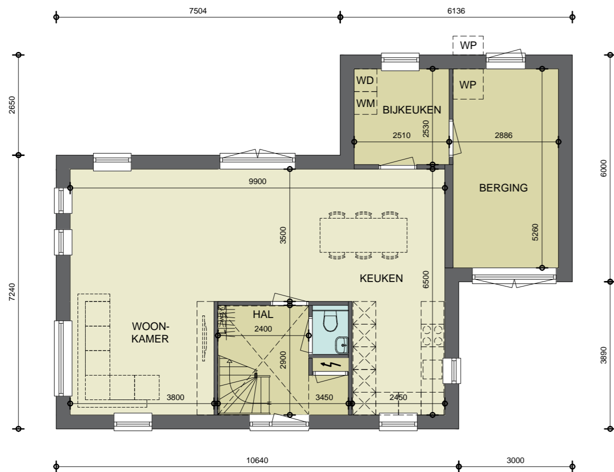
BEGANE GROND OPTIE 2+3: UITPANDIGE BERGING 3000x6000 MM + UITPANDIGE BIJKEUKEN 2650x3136 MM OPTIE 2a: DUBBELE DEUREN BERGING & VLOERVERWARMING
